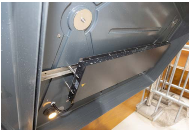
Detailansicht: Ferkelnest-Abdeckung mit Infrarot-Wärmeplatte (FILTech FS300, 1000 x 300 mm, 220-240 V, 50/60Hz)
