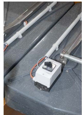
Detailansicht: Schalter zur Temperaturregelung (Stufe 1 und 2)
