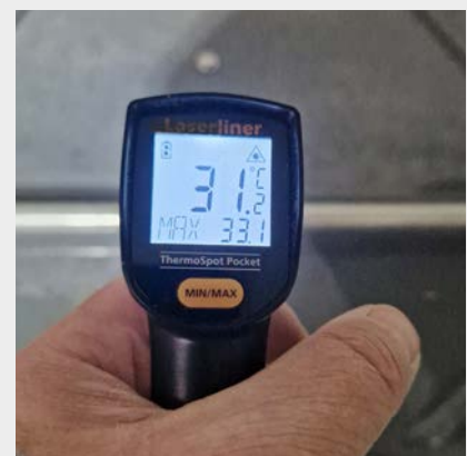
Energie-Messgerät zur Kontrolle der aktuellen Temperatur (hier außen)
