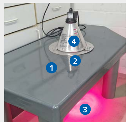
Temperaturversuch mit einer Lampenleistung von 250 Watt (Rotlicht)
