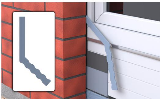
Außenliegender Abdichtungsanschluss an den Tür-/Fensterrahmen: Sorgfältig die EPDM-Dichtung mit dem Funke Fenstereckenrakel andrücken und verkleben.
