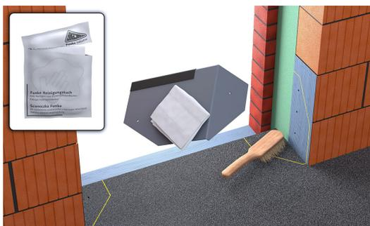
Funke Fensterecken wieder abnehmen, Bohrstaub gründlich von allen Bauteil-Oberflächen und den Funke Fensterecken entfernen (Pinsel liegt dem Set bei) und zusätzlich die Kontaktflächen der Funke Fensterecke mit dem beiliegenden Funke Reinigungstuch reinigen.
