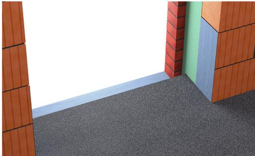
Nur bei erdberührten Stahlbeton-Bodenplatten: Abdichtung der Bodenplatte nach Tabelle 4 von DIN 18533-1, zum Beispiel mit einer Lage Bitumen-Schweißbahn.
