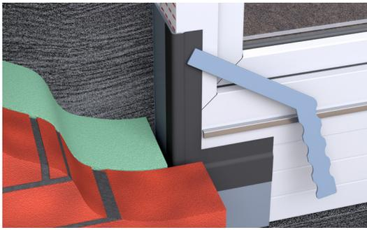
Hier am Bild ohne Vorsatzschale gezeigt, in der die EPDM-Dichtung der Fensterecke mit dem Fenstereckenrakel fest an dem Blendrahmen angedrückt wird.
