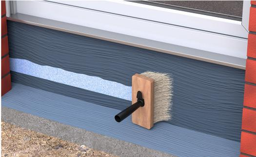
Vervollständigung der außenliegenden Bauwerksabdichtung mit FPD: Aufbringung der FPD (flexible polymermodifizierte Dickbeschichtung) in mindestens zwei Arbeitsgängen, mit einer Mindestrockenschichtdicke von 3 mm.
