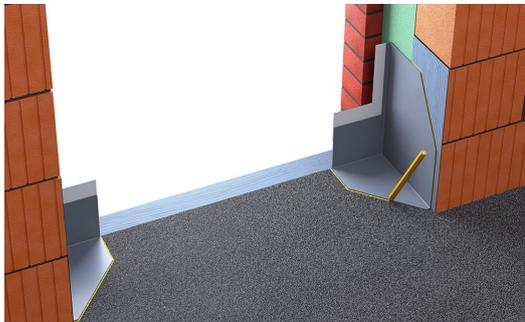
Vorpositionierung (bis an die Vorderkante der „Verlängerung“) und Markierung der beiden Funke Fensterecken an den Laibungen und auf der abgedichteten Bodenplatte, mittels Markierungsstift (im Lieferumfang enthalten).
