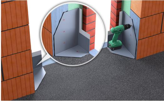
Endmontage der Funke Fensterecken: Funke Fensterecken in die noch frische Funke Fensterecken Dichtmasse eindrücken (Hautbildung darf noch nicht erfolgt sein) und anschließend mit den beiliegenden Schraubdübeln (Beton, Mauerwerk Bit RW 30) bzw. Schrauben (Holz/Holzwerkstoff) zusätzlich fixieren. Schrauben zur Befestigung am Holz/Holzwerkstoffen gehören nicht zum Lieferumfang. Fertig eingebaute, d.h. verklebte und zusätzlich mit Schraubdübeln fixierte Funke Fensterecke:
