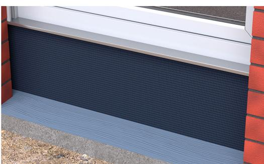
Fertiggestellte Abdichtung mit der Funke SK-Dichtbahn (mit Ausnahme der Sicherung des oberen Rands der Funke SK-Dichtbahn mit geeigneter Klemmschiene). Bei fachgerechter Montage der Funke SK-Dichtbahn ist die Montage einer Klemmschiene nicht erforderlich.
