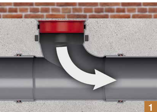
△ 1) Durch die roten Rinnendeckel fließt Jauche in die PVC-Rohre. 2) Nach jedem Entmisten werden die Leitungen mit einem Wasserschwall gereinigt. 3) Dieser entsteht durch das Ablassen angestauten Wassers aus einem 1,4 m höher angebrachten Spülschacht.
