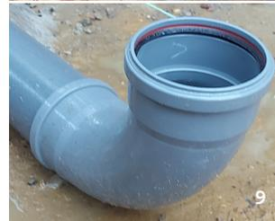
Am Anfang jeder JGS-Rinne sollte das Rohrende so ausgestattet sein, dass dort immer ein 87° JGS-Longbogen Muffe - Muffe Verwendung findet. Der Abstand zwischen JGS-Longbogen und dem 1. Einlauf sollte mindestens 1,00 m betragen. (9)
