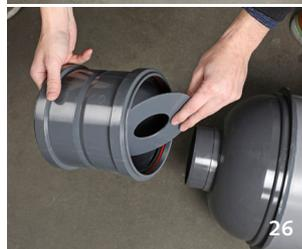
Von einer höheren Montage des Spülschachtes, z.B. Durch Verwendung eines längeren Rohrstückes an Stelle des Kurzstückes DN/OD 110 wird aus hydraulischen Gründen abgeraten. Die Drosselblende wird in die Doppelmuffe eingelegt. (26)
