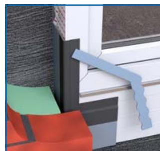
\*Bei der Funke Fensterecke handelt es sich um ein geschütztes, nicht in DIN 18531 und DIN 18533 beschriebenes bzw. geregeltes Einbauteil. Mithin handelt es sich um eine abdichtungstechnische Sonderkonstruktion, die vor Ausführung zwischen Auftraggeber und Auftragnehmer entsprechend zu kommunizieren und zu vereinbaren ist.
